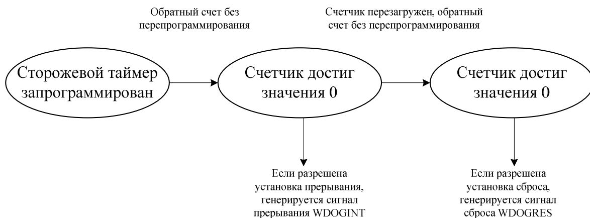
Рисунок 21.1 – Алгоритм работы сторожевого таймера
